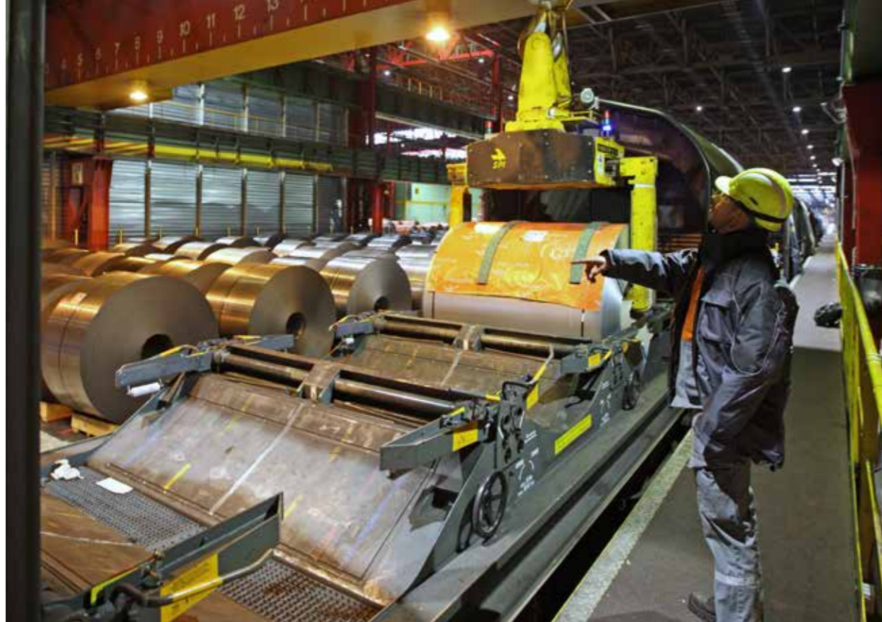
Sur le site d'ArcelorMittal Atlantique et Lorraine situé dans la vallée de la Fensch, à Florange (Moselle). Ici, « les coils » (terme anglais désignant une bobine de tôle issue du laminage à chaud) sont déplacés en vue de leur stockage dans les entrepôts de l'usine.
